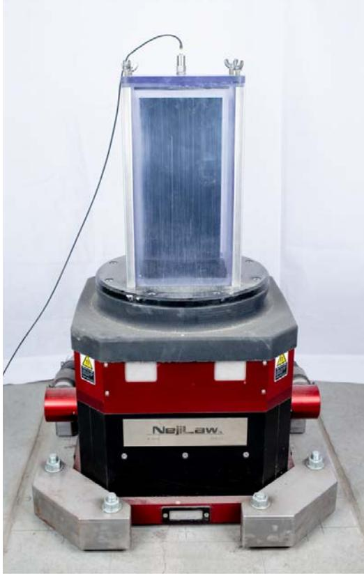
コンクリート打設時に発生する気泡 CB (コンクリートバブル) を消失させる理論を検証したり、新事実や新法則を見出したり、配合毎の最適な変動的慣性力条件を抽出するための基礎研究用の CB 消失装置。
